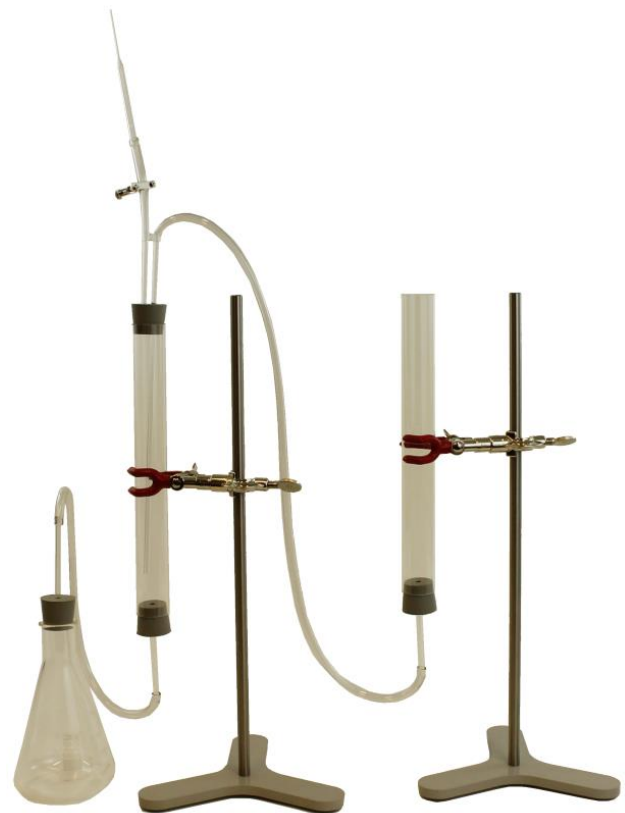
Figur 17: Opstilling af biogasanlæg
