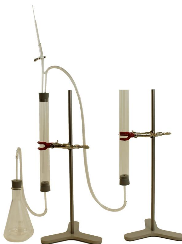
Figur 16: Opstilling af biogasanlæg
