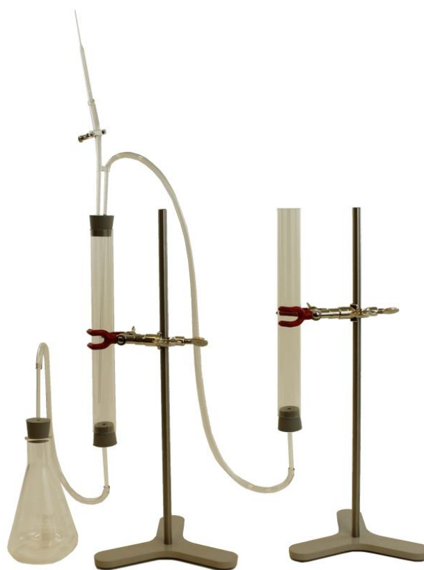
Figur 17: Opstilling af biogasanlæg
