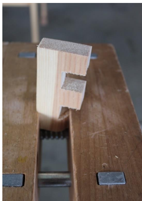
Træklodsen sættes i spænd i en høvlebænk.
