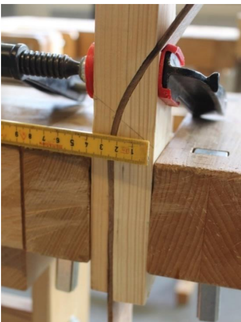
Træstykket, der er spændt i formen, efter det har ligget i varmt vand.
