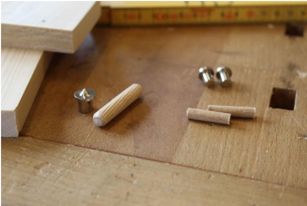
Dyvler og markeringsstifter. Samlingen kan gøres stærkere med lim.
