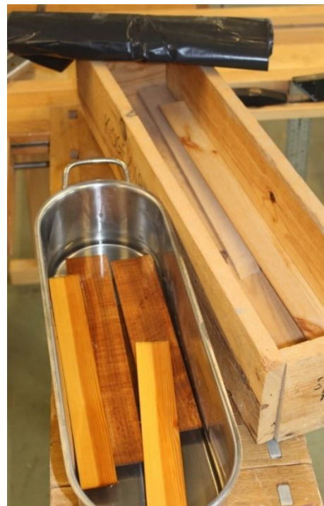
Træstykker blødgøres i varmt vand i ca. 30 minutter.
