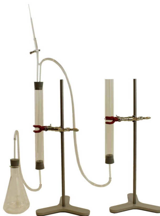
Figur 16: Opstilling af biogasanlæg
